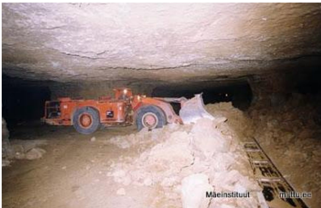
Joonis 4-3 Allmaakopplaadur kaevanduses põlevkivi kraapkonveierile laadimas
