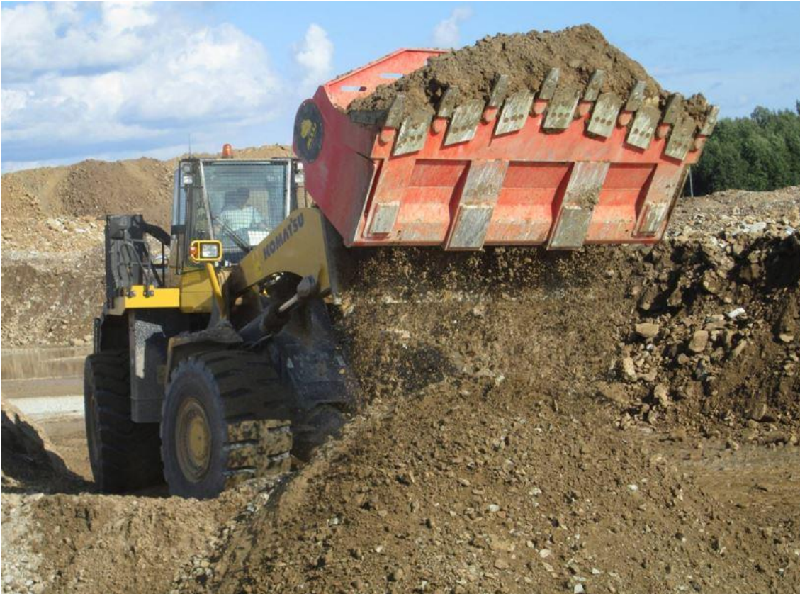
Joonis 14-3 Purustatud materjal väljub kopa alt
