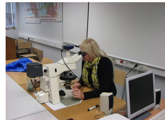
Õhikute mineraalse koostise uurimine polarisatsiooni mikroskoobiga
