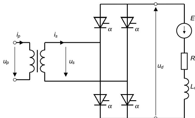
Figure 4.12. Single phase bridge rectifier (B2)
